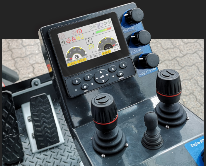
Die C3-Reihe lässt sich mit den 2 Proportional-Joysticks leicht steuern und ermöglicht eine intuitive und millimetergenaue Bedienung.
